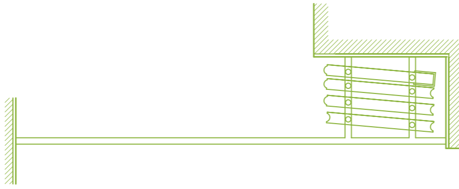
F-förmige lagerung - flush-push lagerung F type collecting way - flush-push type collecting way
